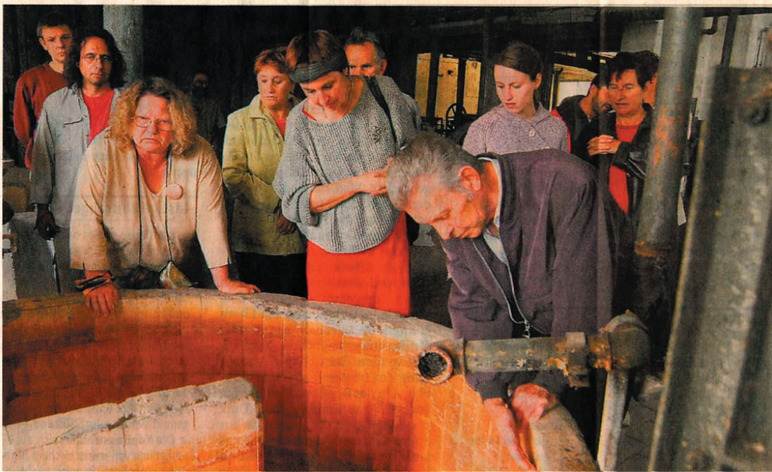
Siegfried Otto zeigte den Besuchern gestern, wie hoch der Papierbrei während der Produktion in den Holländer-Mühlen stand.
